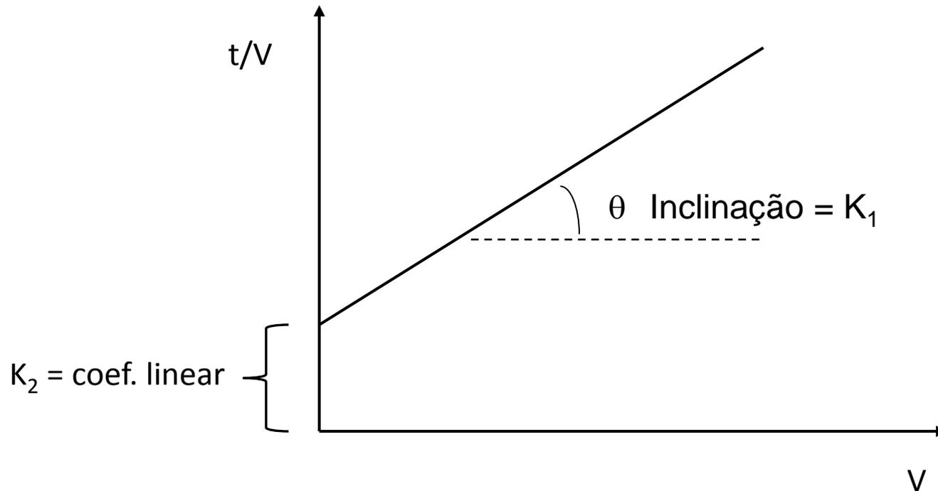
Gráfico para determinação de  $\alpha$  e  $R_m$  em um ensaio de filtração a pressão constante.
